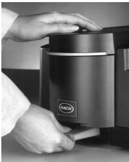
图 7 开启模块锁和取出模块
